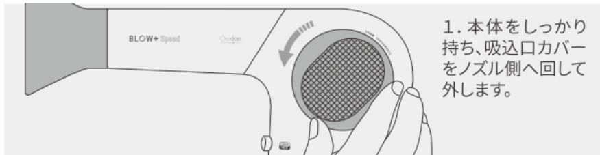
1. 本体をしっかりと持ち、吸入口カバーをノズル側へ回して外します。
