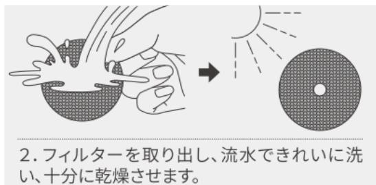
2. フィルターを取り出し、流水できれいに洗い、十分に乾燥させます。
