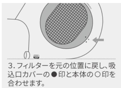
3. フィルターを元の位置に戻し、吸入口カバーの●印と本体の○印を合わせます。
