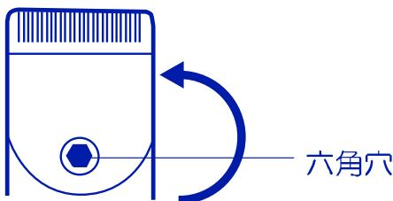
六角穴付きボルトの六角穴に付属の六角棒スパナを差込み、反時計回り（上図の矢印方向）へ回転させ刃を外します。
