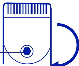
1. 本体の凸部と刃の凹部を合わせ、六角穴付きボルトを差込みます。
