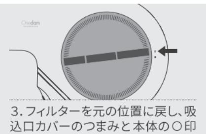
3. フィルターを元の位置に戻し、吸入口カバーのつまみと本体の○印を合わせます。
