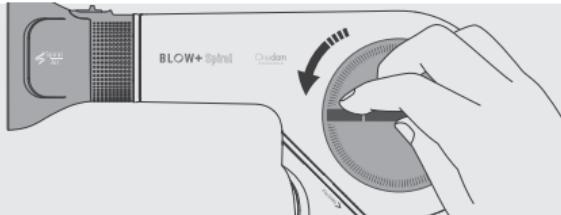
1. 本体をしっかりと持ち、吸入口カバーを●印から○印の方向に回して外します。
