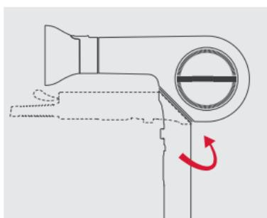
回転ボタンを押し、ハンドルを「FOLDING」の矢印(>)の方向に回します。
